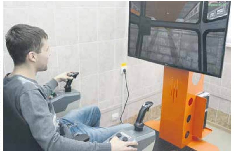
Тренажёр, имитирующий работу машиниста крана
